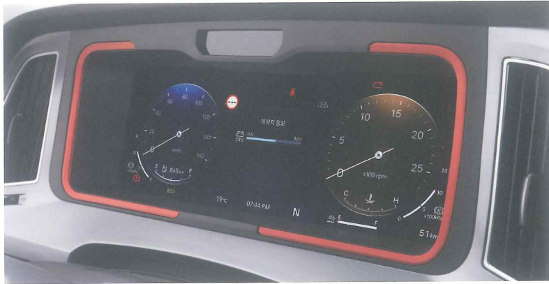
12.3인치 클러스터 / 운전자 주의 경고 카메라 / 베젤 포인트 컬러 12.3인치 LCD 디지털 클러스터와 운전자 주의 경고 카메라, 베젤 포인트 컬러를 적용하여 하이테크한 이미지와 고해상도 화면으로 차량 관련 정보를 얻을 수 있습니다.
